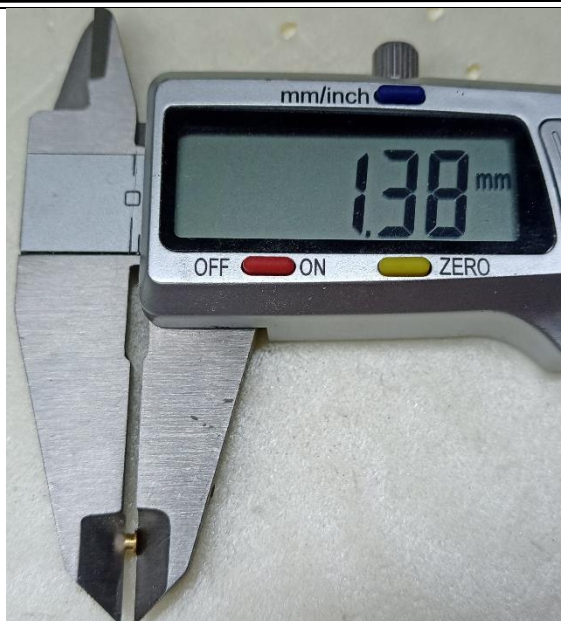
Figuur 10: hoogte van het lager wordt 1,3-1,4 mm
