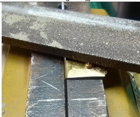
Figuur 9: lager afvijlen in een bankschroef met een stukje messing als houder
