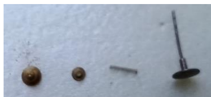
Figuur 4: v.l.n.r.: aslager; bufferring; bufferveer; buffer met steel. Dit alles 4 maal.
