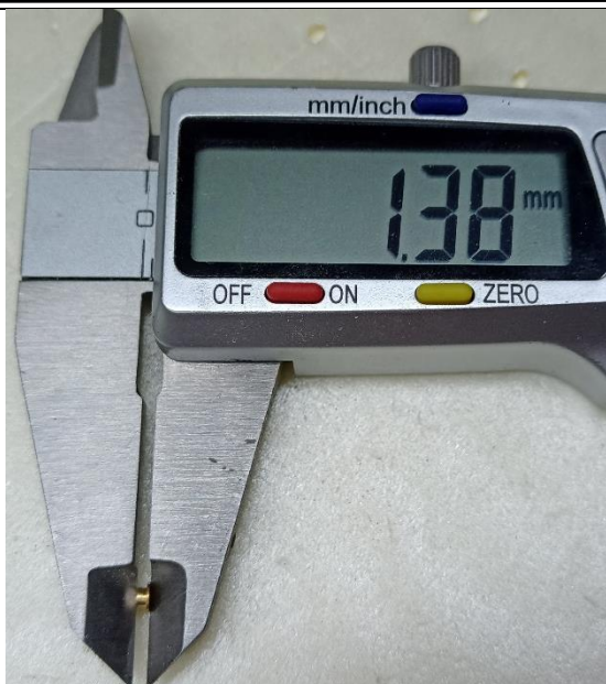
Figuur 10: hoogte van het lager wordt 1,3-1,4 mm
