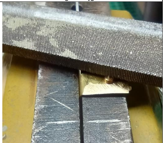
Figuur 9: lager afvijlen in een bankschroef met een stukje messing als houder
