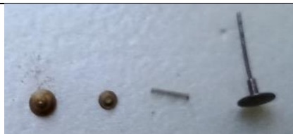
Figuur 4: v.l.n.r.: aslager; bufferring; bufferveer; buffer met steel. Dit alles 4 maal.
