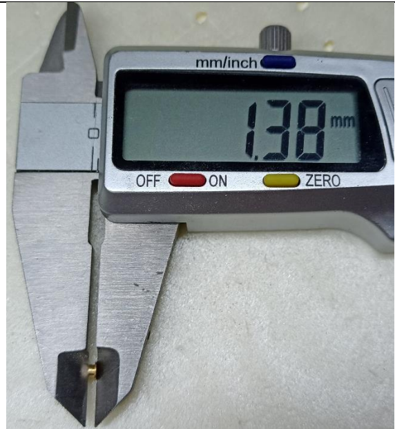
Figuur 10: hoogte van het lager wordt 1,3-1,4 mm
